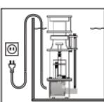
**Para a sua própria segurança, recomenda-se formar um laço com o cabo de conexão à corrente eléctrica que evita que à água escorra pelo cabo até à tomada. Ao usar uma extensão, esta deve ser colocada acima da conexão do filtro à rede eléctrica.**
