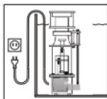
Pro Vaši vlastní bezpečnost doporučujeme na kabelu sítového zapojení vytvořit smyčku, abyste zamezili průniku vody podél kabelu do elektrické zásuvky. Pokud používáte rozdvojku, musí být umístěna v horní části připojení filtru k síti.
