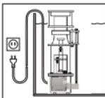
Voor Uw eigen veiligheid is het aan te bevelen met het snoer een druppellus te creëren, die verhindert, dat eventueel langs de kabel lopend water in het stopcontact komt. Bij gebruik van een losse contactdoos dient deze boven de filter-aansluitkabel geplaatst te worden.
