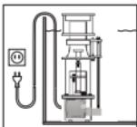
Oman turvallisuutesi kannalta on suositeltavaa tehdä vesilenkki liitoskaapeliin, jolla estetään veden valuminen pistorasiaan johtoa pitkin. Jos käytät jakelupistorasiaa tai ulkoista verkkolaitetta, se on sijoitettava pumpun verkkoliittännän yläpuolelle.
