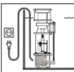
사용자의 안전을 위해서 흐르는 물이 케이블을 따라 소켓 안으로 침투하는 것을 방지하려면 연결 케이블을 고리 모양으로 만드는 것이 바람직합니다. 분배기 소켓이나 외부 전원장치를 사용할 경우 펌프 전기 코드 위쪽에 배치해야 합니다.
