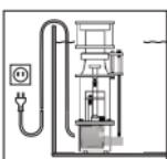
Zaradi lastne varnosti vam priporočamo, da s priključkom tvorite kapljivo zanko. S tem preprečite, vdor vode v vtičnico. Pri uporabi razdelilca za vtičnice ali zunanjega omrežnega dela, mora biti namestitev nad omrežnim priključkom črpalke.
