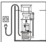
Для Вашей собственной безопасности рекомендуем подсоединительный кабеля свернуть петлей, чтобы избежать попадания в розетку возможно текущей по кабелю воды. При использовании распределительной штепсельной розетки или отдельного блока питания необходимо располагать их выше подсоединения насоса к сети.
