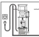
**Per ragioni di sicurezza si consiglia di formare con il cavo elettrico un giro per far gocciolare l'acqua con lo scopo di impedire che viene acqua che scorra lungo il cavo possa entrare nella presa. Se si usa una presa distributrice, la sistemazione deve avvenire al di sopra del collegamento alla rete del filtro.**
