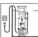
Saját biztonsága érdekében ajánlatos a hálózati vezetéken egy csöpögőhurkot képezni, amely megakadályozza, hogy az esetleg a kábel mentén folyó víz a konnektorba jusson. Ha elosztókonnektort használ, akkor azt a szűrő hálózati csatlakozója fölé kell helyeznie.
