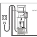
Pour votre propre sécurité, nous vous recommandons de former un col de cygne avec le câble électrique pour éviter que l'eau s'écoulant éventuellement de long du câble ne pénètre dans la prise. En utilisant par exemple une multiprise, celle-ci doit être placée plus haut que la prise de secteur du filtre.
