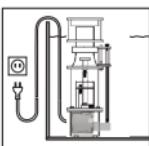
Av säkerhetsskäl rekommenderar vi att man hänger anslutningskabeln till filtret så att en droppöglä bildas och förhindrar att eventuellt på kabeln rinnande vatten kommer in i vägguttaget. Om man använder en grenkontakt i vägguttaget bör detta vara högre placerat än kabelanslutningen i filtret.
