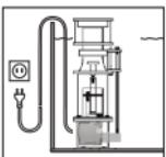
Για τη δική σας ασφάλεια, συνιστούμε να διατηρείτε το καλώδιο ηλεκτρικής παροχής χαλαρωμένο, ώστε ενδεχόμενη διαρροή νερού στο καλώδιο να στάζει στο μέσο χωρίς ποτέ να φτάνει στο ρευματολήπτη. Εάν για την παροχή χρησιμοποιείτε πολύμπριζο, αυτό θα πρέπει να τοποθετείται πάνω από τις ηλεκτρικές συνδέσεις του φίλτρου.
